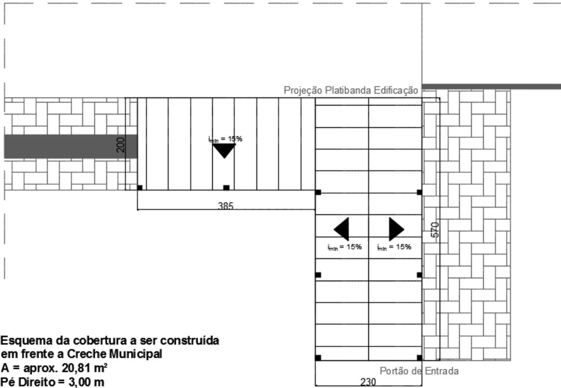
**Esquema da cobertura a ser construída
